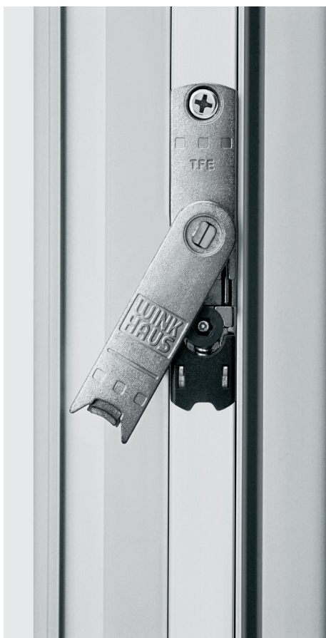
Element wielofunkcyjny to połączenie blokady obrotu klamki, wślizgu i zatrzasku balkonowego. Nie wymaga specjalnego elementu ramowego.
